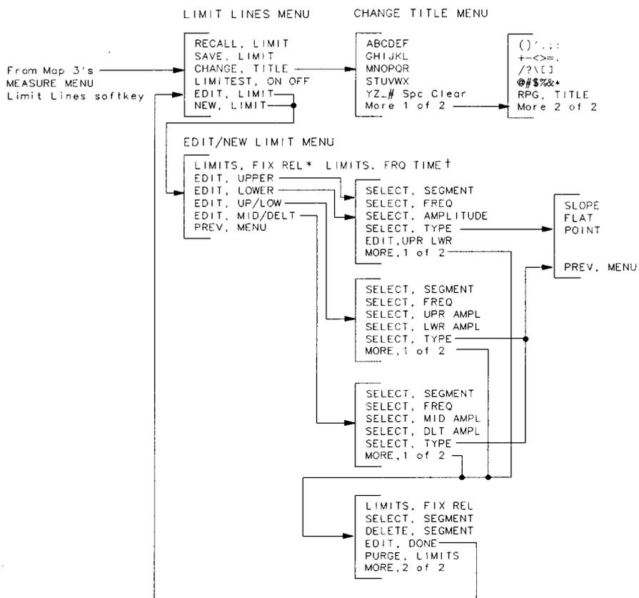
\* HP8590B, HP8591A, HP8593A, HP8594A, HP8595A.
